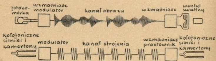
Rys. 94. PRĄD PRZENOSZĄCY OBRAZ I PRĄD SYNCHRONIZUJĄCY W FOTOTELEGRAFII
